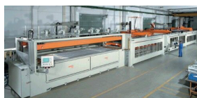
Thermoformage en ligne et fraisage intégré
